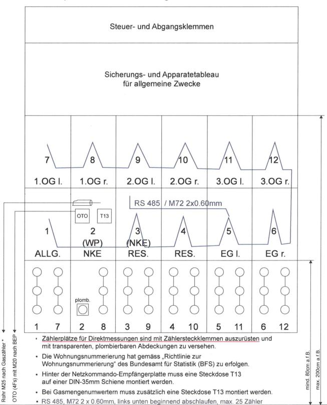
\* falls vorhanden Die Schlaufe muss ab Durchführung mind. 200mm lang sein. Hinter der Apparatetafel ist eine Reserveschlaufe vorzusehen.
